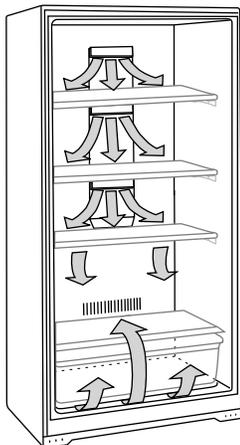
Ne pas obstruer l'une ou l'autre de ces ouvertures d'aération avec des emballages d'aliments. Si les ouvertures d'aération sont bloquées, le courant d'air sera coupé et des problèmes de température et d'humidité peuvent survenir.
