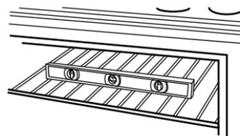
3. Si la cuisinière n'est pas d'aplomb, la tirer de nouveau pour que le pied de nivellement arrière se dégage de la bride antibasculement.
