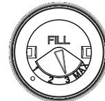
Tourner le régleur à flèche à l'intérieur du distributeur pour modifier le réglage de l'agent de rinçage.
