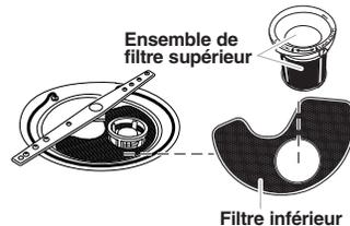
Le système de filtration comporte deux parties, un filtre supérieur et un filtre inférieur.
