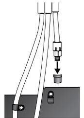
3. Placez la virole (B) et l'écrou en laiton (A) sur l'extrémité du tube en cuivre, comme il est illustré. **Rappel : Ne réutilisez pas** une ancienne virole. L'écrou laiton et la virole sont prévus pour être utilisés avec le Guide d'utilisateur et d'entretien de réfrigérateur.
