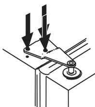
3. Transférez les butées de porte, du bord inférieur de la porte du compartiment des aliments frais et de la porte du congélateur, le cas échéant, vers le côté opposé du bord des portes.
