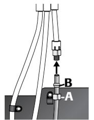
4. Placez l'extrémité du tube en cuivre dans l'orifice d'arrivée du robinet d'eau. Façonnez légèrement le tube – **sans** l'entortiller – pour qu'il pénètre dans l'orifice d'arrivée.
