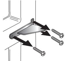
8. Retirez la charnière inférieure ou le support stabilisateur avec un tournevis à tête hexagonale de 0,8 cm ( $\frac{3}{8}$  po) et conservez les vis pour une utilisation ultérieure. Soulevez la fiche de la charnière inférieure (sur les modèles de porte de congélateur).
