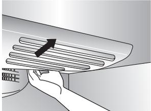
2. Ejerciendo una presión firme, oprima hacia adelante las muescas que se encuentran en la parte trasera de la cubierta y tire hacia abajo. La cubierta se abre desde atrás.
