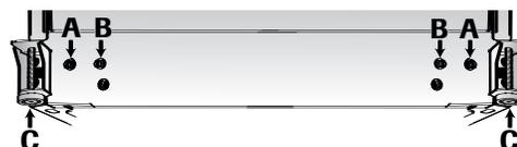
3. Tourner chacune de ces vis de réglage **(B)** à l'aide de la douille-tournevis pour relever ou abaisser l'arrière du réfrigérateur.
