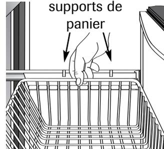
7. Coulissez le panier supérieur dans l'appareil. Assurez-vous que l'arrière du panier est accroché derrière l'arrêt de glissière.
