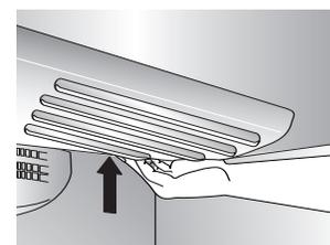
6. Introduisez les taquets avant du cabochon dans les fentes de la doublure du congélateur et enclenchez la partie arrière par-dessus la lampe pour emboîter le taquet arrière
