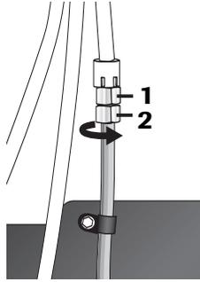
Con una segunda llave inglesa ajustable girar la tuerca interior **(2)** en sentido antihorario y apretar totalmente mientras mantiene la tuerca superior en posición.
