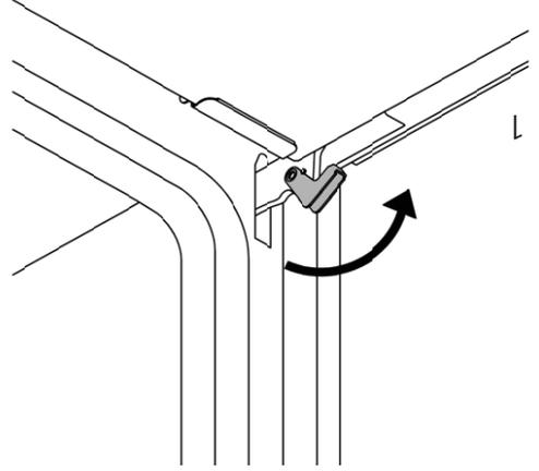
Les panneaux intérieurs de la porte vitrée peuvent être aisément retirés pour être nettoyés. Il n'est pas nécessaire de démonter la porte pour nettoyer la vitre en verre. La vitre peut être nettoyée directement ou retirée.
