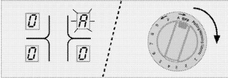
2. Tournez le bouton de commande de la table de cuisson dans le sens antihoraire pour régler le niveau de chauffage (on suppose que le niveau 7 est sélectionné pour l'exemple).
