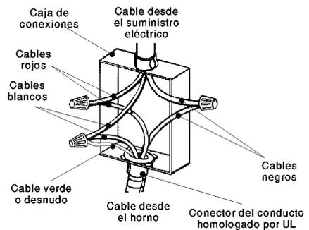
Consulte la figura A, donde los códigos locales permiten la conexión del cable A TIERRA desde el horno al cable NEUTRO del circuito derivado (cable de color gris o blanco):
