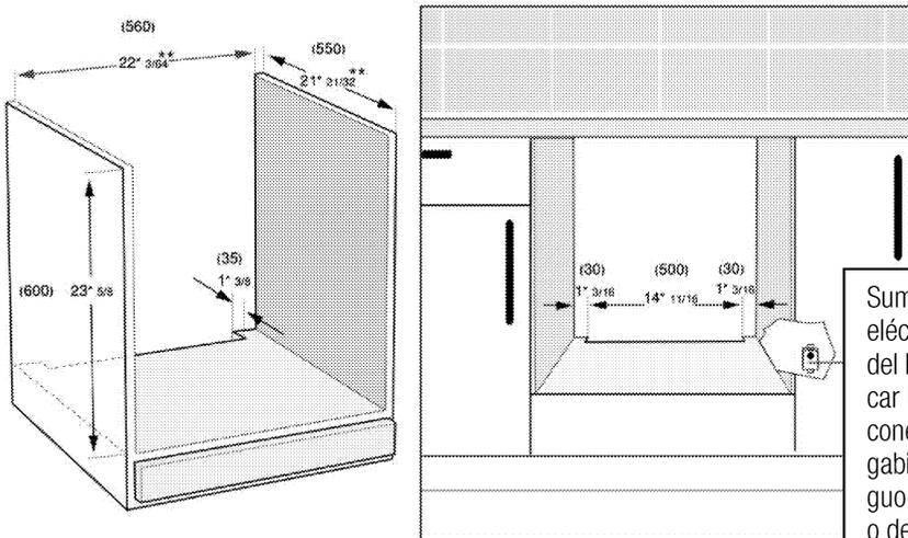
Suministro eléctrico del horno: colocar la caja de conexiones en el gabinete contiguo o debajo de la superficie de soporte inferior
