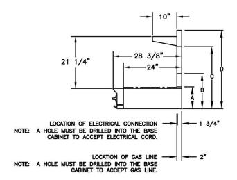
A - ISLAND TRIM HEIGHT - 9" B - 6" STANDARD BACKGUARD HEIGHT - 14-3/8" C - 17" BACKGUARD HEIGHT - 25-3/8" D - HIGH SHELF BACKGUARD HEIGHT -  $32\ 1/8$ "
