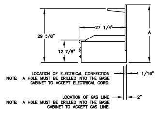
A-HIGH SHELF BACKGUARD HEIGHT - 25-3/8" HIGH SHELF BACKGUARD HEIGHT - 32 5/8" HIGH BACKGUARD HEIGHT - 32 5/8"
