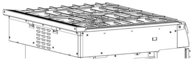
Figure 3: Nueva moldura para islas instalada
