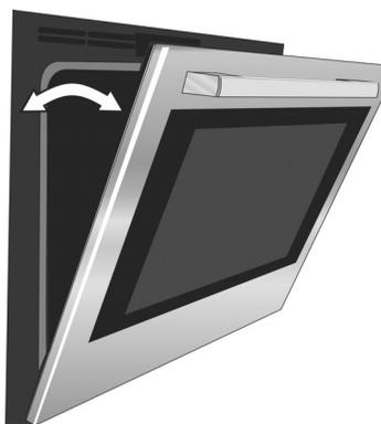
4. Fermer la porte du four jusqu'à ce qu'elle s'accroche sur les leviers d'arrêt des charnières, en bloquant les charnières à l'angle adéquat afin de pouvoir retirer la porte. La porte sera ouverte d'environ 7 po (17,8 cm) sur la partie supérieure. Ceci a pour effet d'éliminer la tension des ressorts exercée sur les charnières ce qui permet de soulever aisément la porte.
