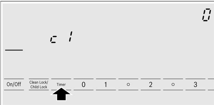
3. Pulse la tecla **Timer** hasta que se muestre el indicador para la función requerida.
