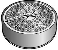
Pour des résultats de cuisson optimaux, le diamètre de la zone ferromagnétique de l'ustensile utilisé devrait correspondre à la taille de l'élément. Si un ustensile de cuisine n'est pas détecté sur un élément, essayez de nouveau sur un élément plus petit.
