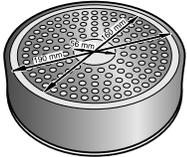
Para obtener buenos resultados de cocción, se recomienda que el diámetro del área ferromagnética del recipiente se ajuste al tamaño de la zona de cocción. Si el recipiente no es detectado en una zona de cocción, pruébelo en la zona de diámetro inmediatamente inferior.
