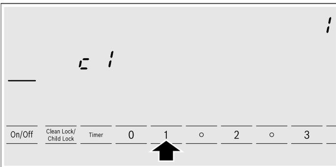
5. Pulse la tecla **Timer** nuevamente durante 4 segundos, hasta que escuche una señal audible. Los valores se han almacenado correctamente.
