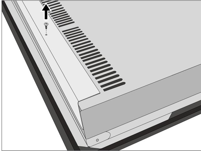
Tras desempaquetar la placa, desatornillar el deflector metálico (ver imagen).
