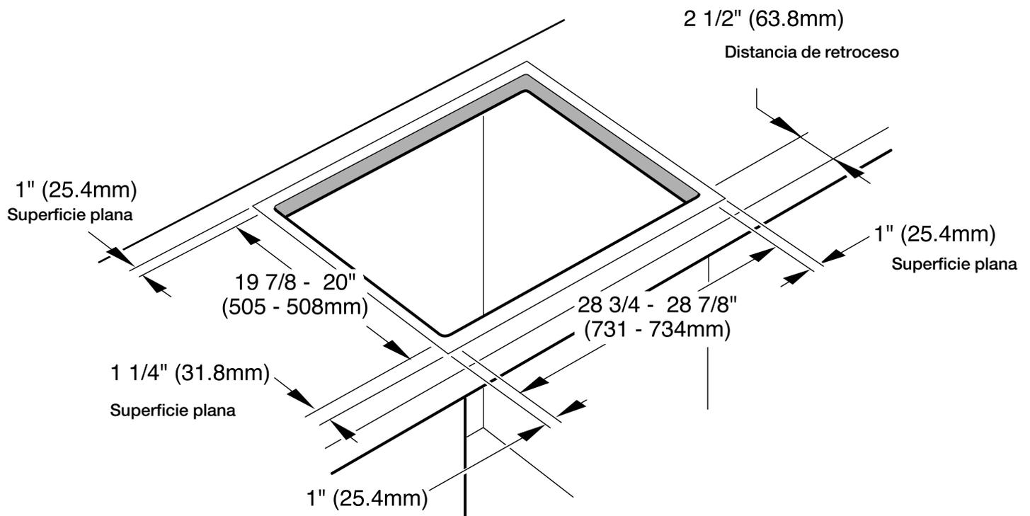
Después de preparar el hueco, retire las virutas, ya que pueden afectar el funcionamiento de los componentes eléctricos.
