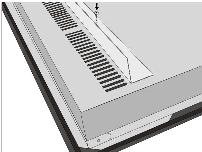
Vissez l'écran de ventilation à la base de la boîte de brûleur en utilisant les trous prépercés, tel que montré dans l'illustration.
