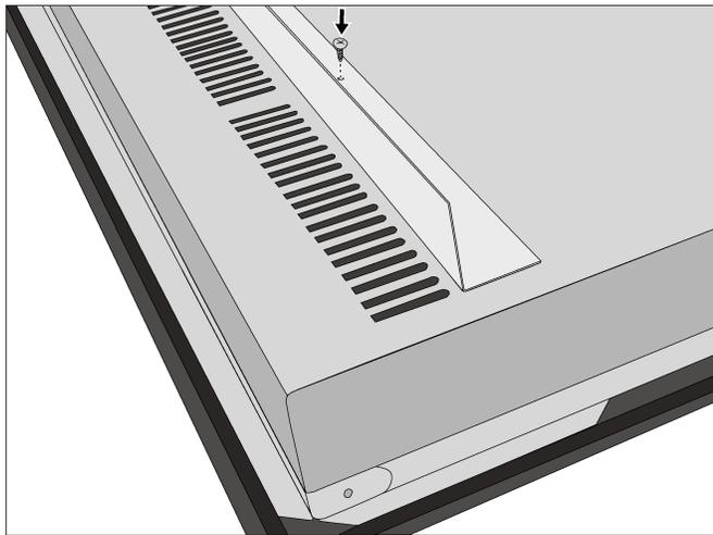
Atornillar el deflector metálico en los agujeros situados en la base de la chapa envolvente, tal y como se muestra en la imagen.
