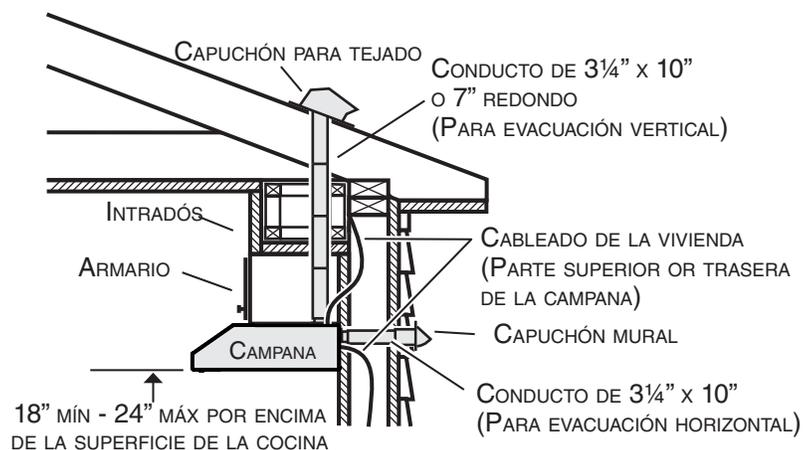
NOTA: Las distancias superiores a 24" son a discreción del instalador y del usuario.
