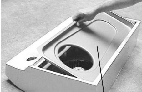
CUBIERTA INFERIOR RECUBIERTA DE TEFLON® (Se encuentra fija con 2 tornillos)
