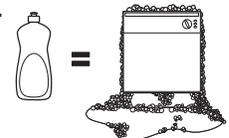
**REMARQUE :** Si vous utilisez un détergent qui n'est pas conçu pour les lave-vaisselle, il se formera de la mousse à l'intérieur de l'appareil. Pendant le fonctionnement, cette mousse sortira par les événements de l'appareil et s'écoulera sur le plancher de cuisine.
