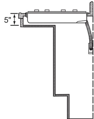
Pour les modèles à touche tactile et bouton de rétroéclairage, allouez une profondeur minimale de 6 1/2 po entre le comptoir et l'enceinte (tous les autres modèles). (Tous les autres modèles)
