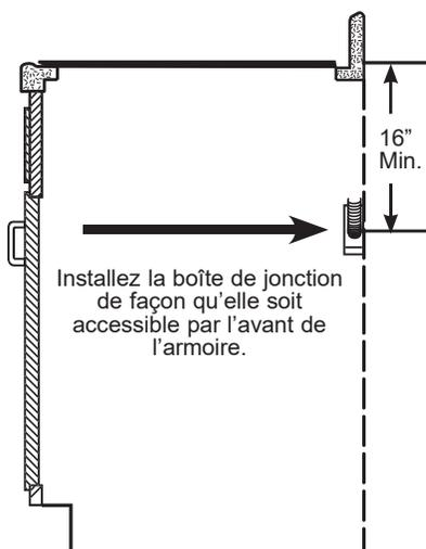
Installez la boîte de jonction de façon qu'elle soit accessible par l'avant de l'armoire.
