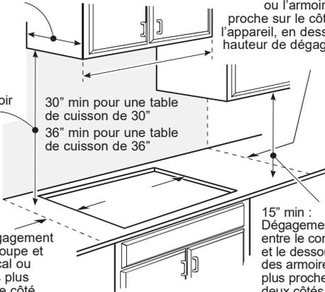
Si un dégagement de 30 po entre la table de cuisson et les matériaux combustibles ou l'armoire métallique au-dessus ne peut pas être maintenu, un dégagement minimum de 24 po est alors nécessaire et le dessous des armoires au-dessus de la table de cuisson doit être protégé avec un carton à l'enrouleuse isolant (insulating millboard) d'au moins 1/4 po d'épaisseur recouvert d'une tôle d'un calibre minimal de 30 (0,0125 po d'épaisseur).
