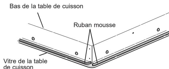
**REMARQUE :** Sur les modèles ZEU30 et ZEU36, appliquez le ruban mousse autour du bord extérieur de la vitre, sur les côtés et l'arrière de l'appareil seulement.
