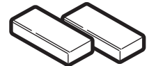
Bloques de relleno o pedazos de madera, si son necesarios para rellenar el gabinete (usados solamente en la instalación de gabinetes apoyados)
