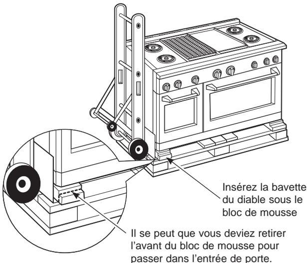
**IMPORTANT :** Ne retirez pas le bloc de mousse de base pendant l'utilisation du chariot manuel. Placez la lame du chariot sous le bloc de mousse puis transportez la cuisinière à sa destination finale.
