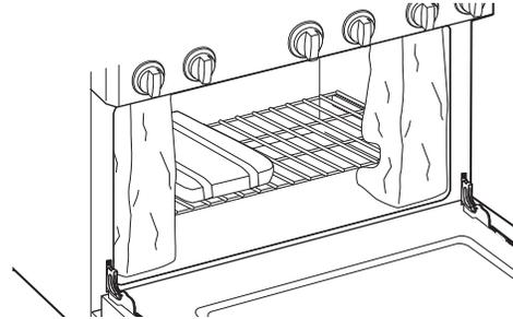
**ATTENTION** Les portes et les voies de passage menant à l'emplacement d'installation requièrent un espace de (80 cm) 32". Si l'espace est inférieur à 80 cm, la (les) porte(s) du four et les boutons de commande doivent être retirées.
