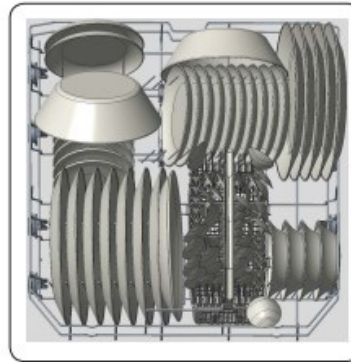
Le modèle de chargement de la grille inférieure permet de placer 10 couverts.
