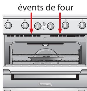
Figure 10 : Emplacement de l'évent de four
