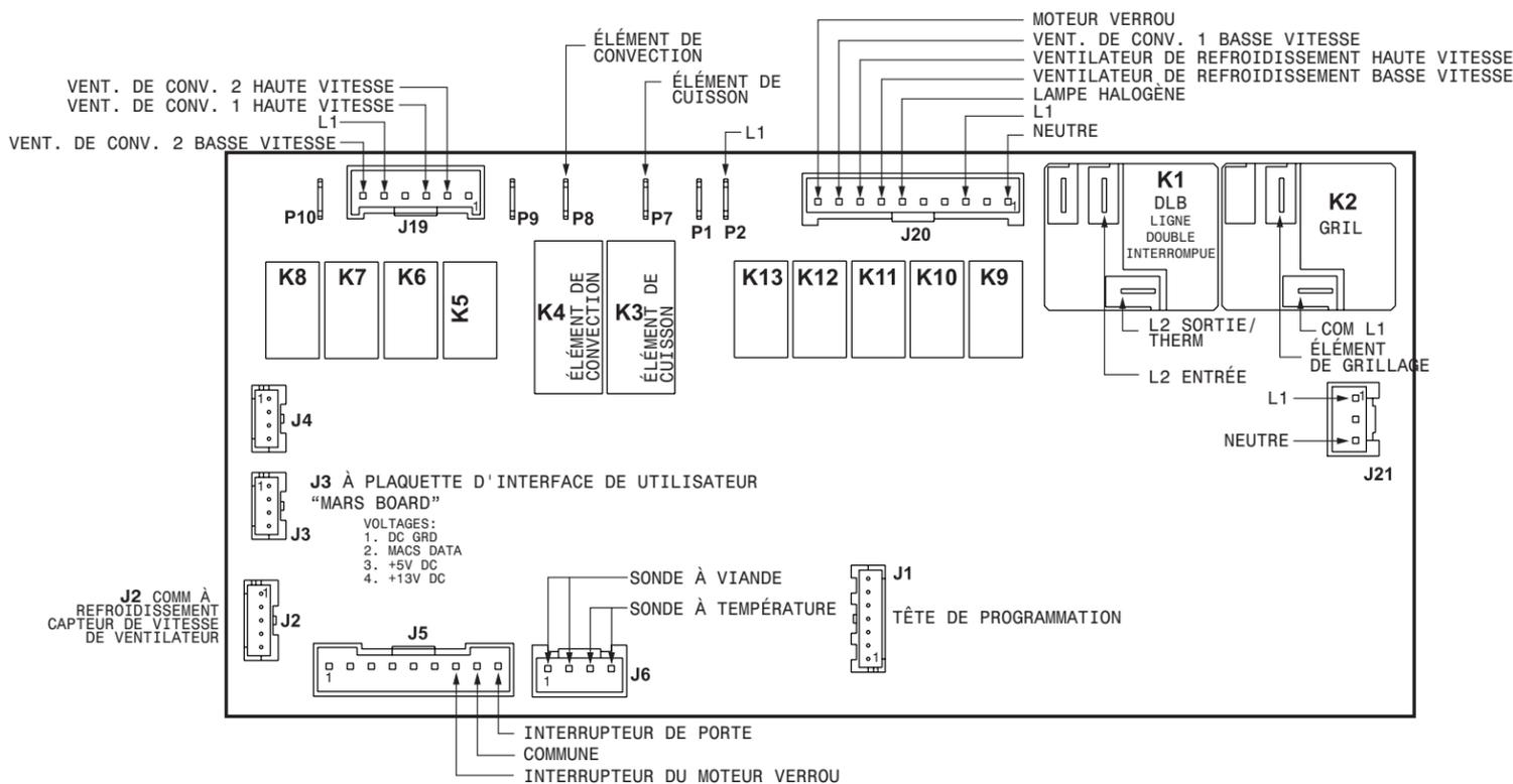
**SINGLE WALL OVEN CIRCUIT // CIRCUITO DEL HORNO DOBLE // CIRCUIT DU FOUR DOUBLE**
