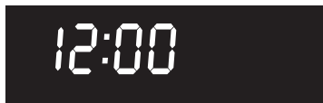
Figure 7 : « 12:00 » clignote sur l'afficheur lorsque le four est mis sous tension ou après que le courant est rétabli après une panne.
