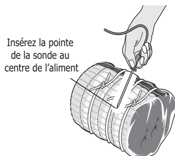
Figure 26 : Positionnement correct de la sonde
