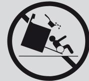
Afin de réduire les risques de renversement, l'appareil doit être fixé au moyen du support anti-renversement fourni avec l'appareil. Ce dernier doit être installé correctement. Reportez-vous aux instructions d'installation pour installer correctement le support anti-renversement.
