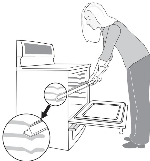
Figure 21 : Replacer la grille de four
