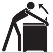
Pour vérifier si le support anti-renversement est correctement installé, attrapez le bord arrière de la cuisinière à deux mains. Essayez doucement de faire basculer la cuisinière vers l'avant. Lorsque le support est correctement installé, la cuisinière ne doit pas basculer vers l'avant.
