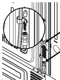
Retirer le bouchon en plastique du raccord d'entrée d'eau
