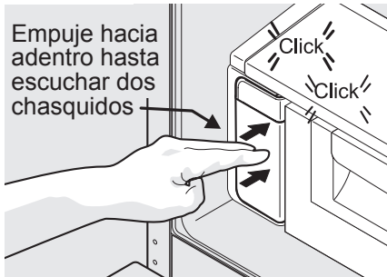
Reinstalación del filtro de agua
