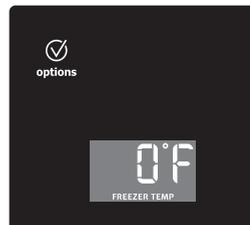
L'affichage de la température commencera à clignoter lorsque vous appuierez pour la première fois sur l'un ou l'autre des indicateurs. Après cinq secondes d'inactivité, l'afficheur émet un signal sonore pour indiquer que la nouvelle température est activée. Après 10 secondes, l'afficheur revient à l'affichage de base.
