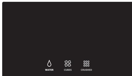
Le mode de veille affiche seulement les options concernant l'eau (water), les glaçons (cubes) et la glace concassée (crushed). Appuyez sur une icône pour activer le mode du distributeur désiré. Le mode activé du distributeur est mis en surbrillance.
