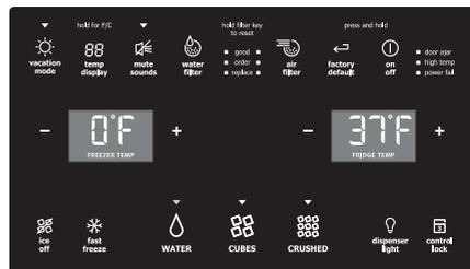
Votre réfrigérateur est équipé de l'affichage du tableau de commande muni d'un panneau Glass-Touch. Il vous suffit d'effleurer l'écran pour activer les commandes. Il existe trois modes pour le distributeur :
