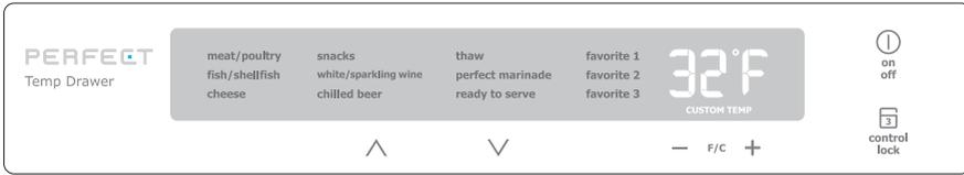
Le tiroir à température parfaite **Perfect Temp<sup>MC</sup>** est conçu pour conserver les aliments à une température précise, soit plus fraîche, plus chaude ou la même que le compartiment à aliments frais. Le réglage de décongélation maintient une température pour décongeler des aliments pendant 12 heures. À la fin de cette période, il passe ensuite au réglage snacks pour conserver les aliments décongelés.
