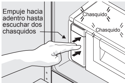
Reinstalación del filtro de agua
