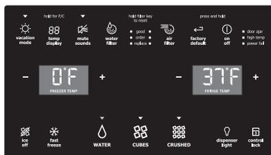
**Porte entrouverte** Si la porte a été laissée ouverte pendant une durée prolongée, une alarme retentit et le témoin de la porte entrouverte s'affiche sur le côté droit du panneau de commande. L'alarme est désactivée en fermant la porte. La touche de mise en sourdine clignote pour demander la réinitialisation de toute alarme en attente. Appuyez sur cette touche pour réinitialiser les alarmes du système.
