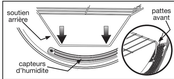
Placez les articles à sécher sur le dessus de l'étagère de sorte qu'il y ait de l'espace entre eux et qu'ils ne pendent pas des côtés ou par les trous. Le poids de l'ensemble des articles ne doit pas dépasser 4,5 kg (10 lb). Sélectionnez le réglage **air** (sans chaleur) pour les articles contenant du plastique, du caoutchouc mousse, des matériaux caoutchouteux, des plumes ou du duvet.
