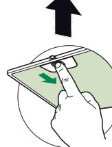
Reemplace los filtros de grasa metálicos retirados previamente.
