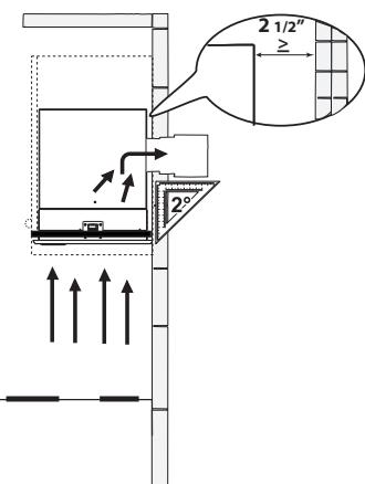
Pour l'installation d'une canalisation horizontale (à l'arrière), un espace d'au moins  $2\frac{1}{2}$ " est requis entre l'arrière de la hotte encastrable et le mur.
