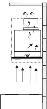
Para la ventilación de recirculación sin conducto, dirija la tubería a una ubicación por encima de la campana donde la descarga se ventila de regreso a la sala.
