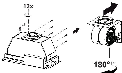
Pour l'installation d'une canalisation horizontale, le moteur doit d'abord être détaché. Pour ce faire, retirez les 12 vis comme illustré.
