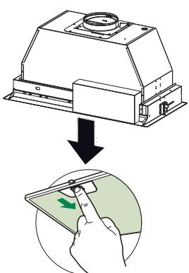
Retirez les trois filtres de la hotte encastrable avant de l'installer dans l'armoire.
