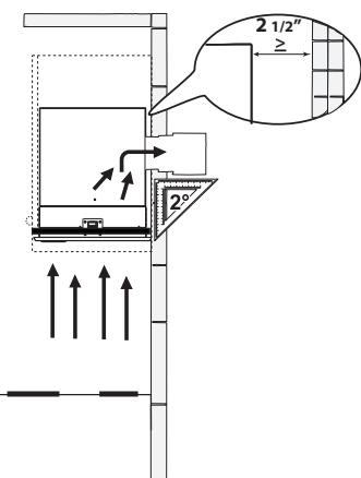
Para conductos horizontales (posteriores) debe haber un mínimo de 2 1/2" de espacio abierto entre la parte posterior de la campana de inserción y la pared.
