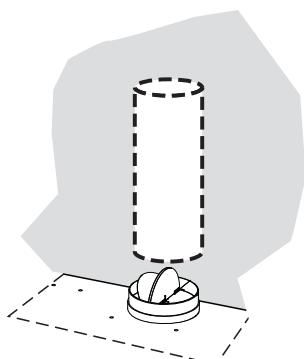
Installez le clapet de toiture ou le clapet mural acheté séparément. Raccordez le conduit métallique de 6" au clapet de toiture ou au clapet mural, puis raccordez les conduits.
