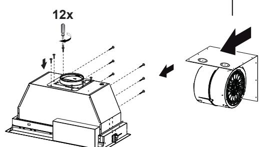
Lorsque les vis sont enlevées, dégagéz le ventilateur du bâti de la hotte encastrable et placez-le de façon à ce que l'ouverture de passage de l'air se trouve face au mur arrière (dégagez-le de l'arrière et faites-le tourner de 180 degrés vers la gauche, puis inclinez-le de 90 degrés vers l'arrière, comme illustré dans le diagramme).
