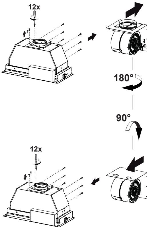
Para una instalación de conductos horizontales, el motor necesita ser desbloqueado retirando primero los 12 tornillos como se muestra.
