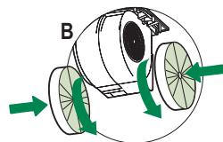
**Atención:** "Cuando se utiliza en modo de recirculación, para reducir el riesgo de incendio y descarga, use solo el kit de conversión Modelo FILTER 1 O FILTER1LL
