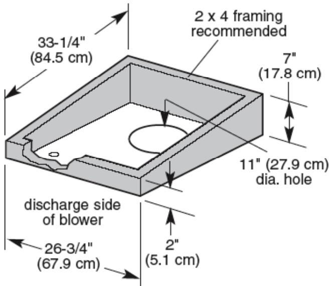
**Pour l'installation du ventilateur extérieur sur un toit plat :**
