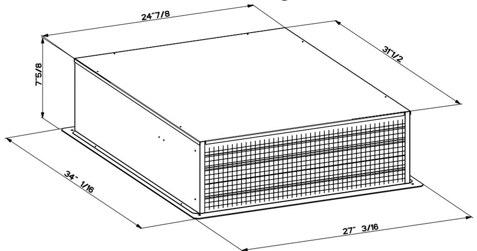
**MAKE SURE THAT THE DISCHARGE END OF THE REMOTE BLOWER FACES AWAY FROM THE DIRECTION OF PREVAILING WINDS.**
