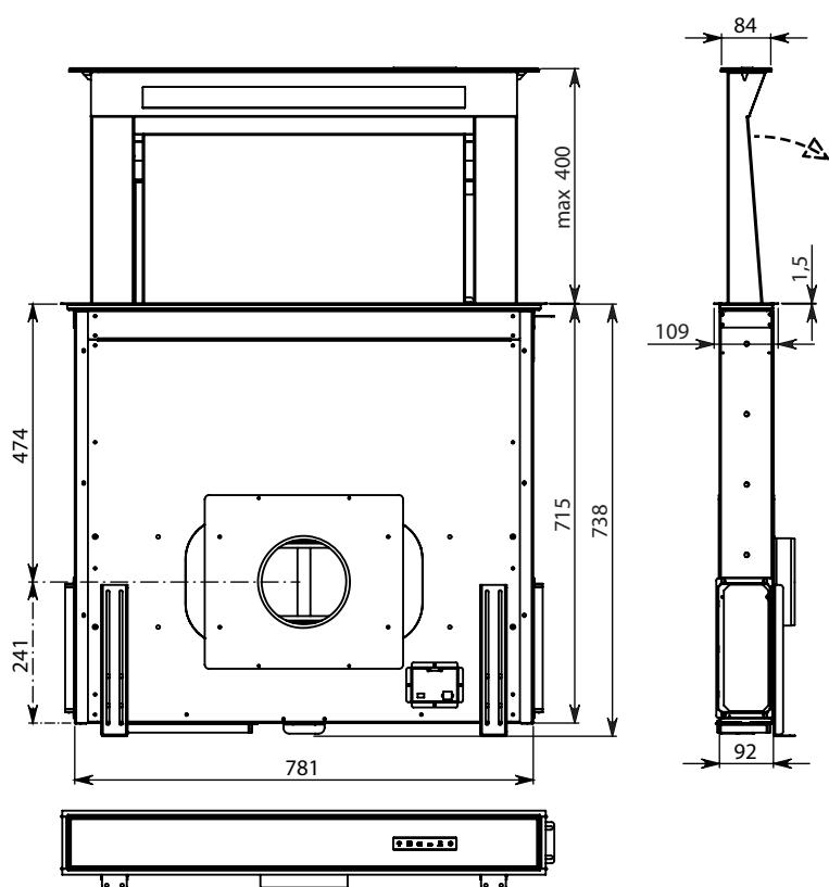
CZ - Montáž se zadním motorem
