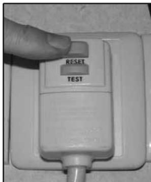
Le cordon d'alimentation contient un dispositif de courant qui détecte la détérioration du cordon d'alimentation. Pour tester votre cordon d'alimentation procédez comme suit:
