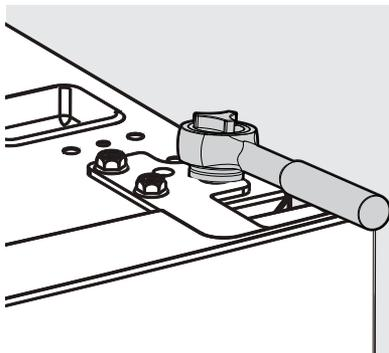
4. Retire el pasador con una llave inglesa. Voltee el soporte de la bisagra y coloque el pasador en el lado opuesto del soporte.
