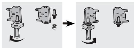
11. Fije el soporte de la bisagra inferior a la unidad. (Vea la Figura A.) Reemplace ambas patas ajustables. (Ver la Figura B.)
