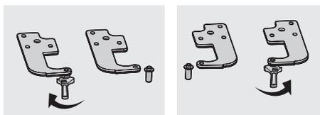
5. Mueva el interruptor de puerta de la cubierta de la bisagra derecha a la cubierta de la bisagra izquierda (bolsa de accesorios).
