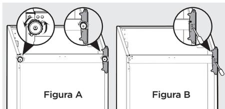
10. Retire el pasador de la bisagra inferior con una llave inglesa, gire el soporte y vuelva a colocarlo en el lado opuesto.
