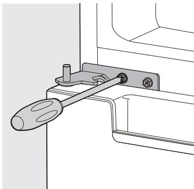
15. Reemplace la puerta superior. Coloque la puerta en la bisagra central y alinéela con el refrigerador asegurándose de que las juntas de la puerta queden bien sellados con el refrigerador. Fije firmemente la bisagra superior al refrigerador.
