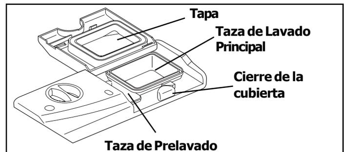
**Nota:** Si la cubierta está cerrada en la copa de lavado principal, abrir presionando el cierre de la cubierta.
