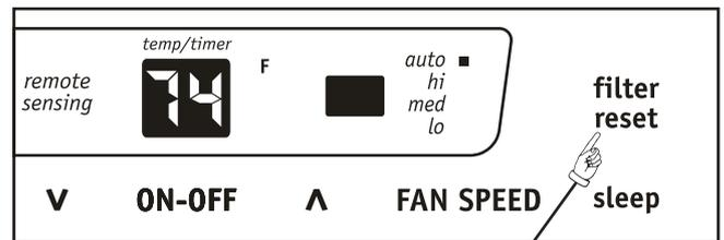
Nota: Esta función es un recordatorio para limpiar el filtro de aire (vea 'Cuidados y limpieza') para conseguir un rendimiento más eficiente. El LED (luz) se iluminará después de 250 horas de operación. Para reestablecer después de limpiar el filtro, oprima el botón "Filter Reset" y la luz se apagará.
