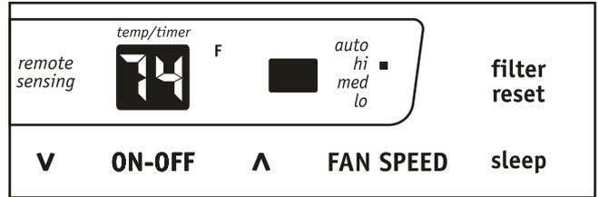
Nota: Pulse una vez o mantenga presionado tanto el botón arriba ( Λ ) como el botón abajo ( V ) hasta que se muestre la temperatura deseada en la pantalla. Esta temperatura se mantendrá automáticamente entre 60 °F (16 °C) y 90 °F (32 °C). Si quiere que la pantalla muestre la temperatura actual de la estancia, consulte la sección "Para operar sólo en modo ventilador" en la página 7.
