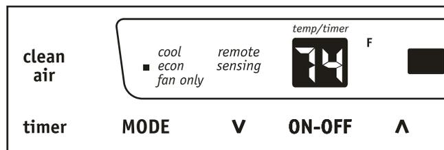
Nota: En este modo, el ventilador continuará a funcionar por 1 minuto después de que el compresor se apague. El ventilador después se enciende durante 20 segundos en intervalos de 10 minutos hasta que la temperatura esté por encima de la seleccionada, momento en el cual el compresor se volverá a encender.
