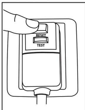
Le cordon d'alimentation contient un dispositif de courant qui détecte la détérioration du cordon d'alimentation. Pour tester votre cordon d'alimentation procédez comme suit :
