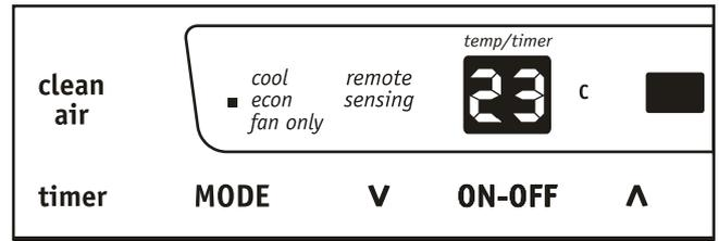
Remarque : Dans ce mode, le ventilateur continuera à fonctionner pendant 1 minute après que le compresseur s'éteigne. Le ventilateur se met ensuite en marche pendant 20 secondes à des intervalles de 10 minutes jusqu'à ce que la température ambiante soit plus élevée que la température réglée, à ce moment le compresseur se remet en marche.
