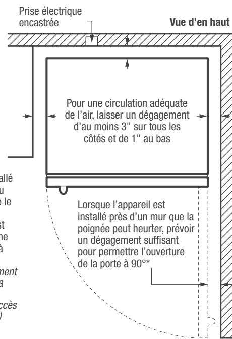
\* Lorsque le congélateur est installé près d'un mur, d'une armoire ou d'un autre appareil qui dépasse le bord avant du congélateur, un dégagement minimal de 20" est recommandé pour permettre une ouverture optimale de la porte à 140°, pour l'accès ou le retrait complet du panier. (Le dégagement minimal absolu de 3" permettra l'ouverture de la porte à 90° SEULEMENT, ce qui limitera l'accès au panier, ainsi que son retrait.)
