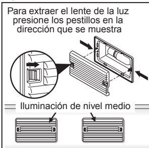
Extracción de la lámpara de iluminación de nivel medio
