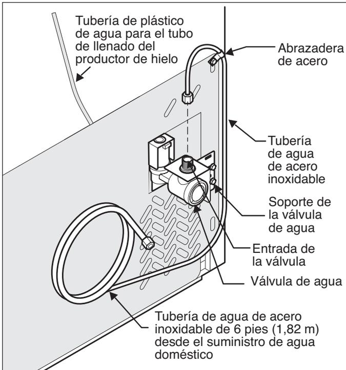
**Figura B. Conexión de la tubería de agua de acero inoxidable**
