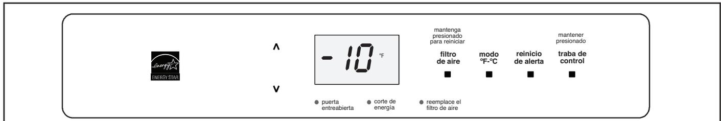
Para regular la configuración de temperatura, en el panel de control presione la tecla ARRIBA (▲) para temperatura más cálida y la tecla ABAJO (▼) para temperatura más fría. Espere varias horas entre los ajustes para que la temperatura se estabilice. El congelador se puede regular entre -10 °F (-23 °C) y 10 °F (-12 °C). Al presionar la tecla MODO DE TEMPERATURA, la pantalla de temperatura alternará entre °F y °C.
