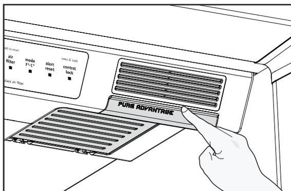
Cubierta de filtro de aire abierta
