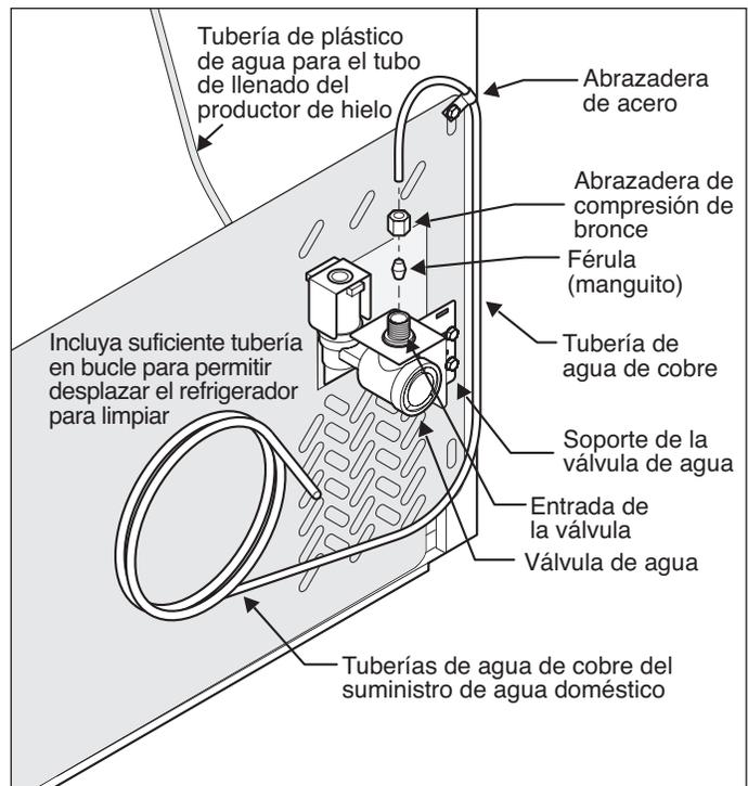
Figura A. Conexión de la tubería de agua de cobre
