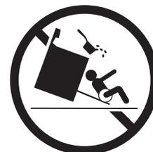
Afin de réduire les risques de renversement, la cuisinière doit être fixée au moyen du support anti-renversement fourni avec la cuisinière. Ce dernier doit être installé correctement. Pour vous assurer que le support est installé correctement, vérifiez que le pied de mise à niveau arrière est inséré et fixé solidement dans le support anti-renversement en enlevant le panneau inférieur ou le tiroir de rangement de la cuisinière.
