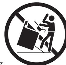
Dans le cas des modèles comportant un tiroir réchaud ou un four inférieur, agrippez le bord supérieur arrière de la cuisinière et essayez de la pencher doucement vers l'avant. Reportez-vous aux instructions d'installation pour installer correctement le support anti-renversement.
