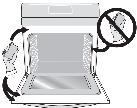
Figure 19 : Nettoyer autour du joint de porte du four
