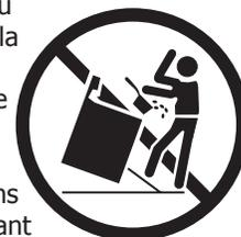
Dans le cas des modèles comportant un tiroir réchaud ou un four inférieur, agrippez le bord supérieur arrière de la cuisinière et, avec précaution, tentez de la pencher vers l'avant. Reportez-vous aux instructions d'installation pour installer correctement le support anti-renversement.
