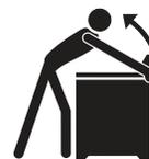
Pour vérifier si le support anti-renversement est correctement installé, attrapez le bord arrière de la cuisinière à deux mains. Essayez doucement de faire basculer la cuisinière vers l'avant. Lorsque le support est correctement installé, la cuisinière ne doit pas basculer vers l'avant.
