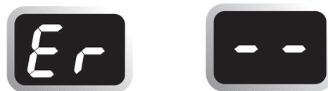
Figure 7 : Message Er du voyant (G) et fonction de verrouillage ESEC (D)
