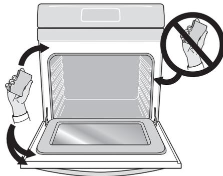
Figure 39 : Nettoyer la partie autour du joint de la porte du four
