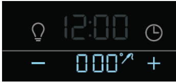
Figure 24 : Sonde insérée et prête pour le réglage de la température
