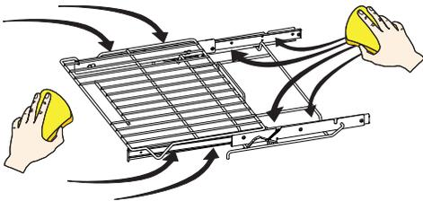
3. Agitez la lubrification au graphite avant l'application. Appliquez sur les guides de chargement et l'axe de rotation. Répétez sur les deux côtés de la grille à glissière.
