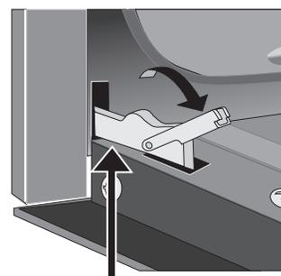
Figure 27: Déverrouillez les charnières pour retirer la porte
