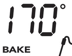
**Figure 16 : Sonde détectée affichant sa température**
