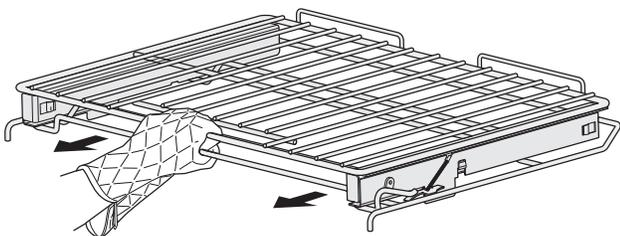
**Figure 3: Tirez la grille à la position d'arrêt**
