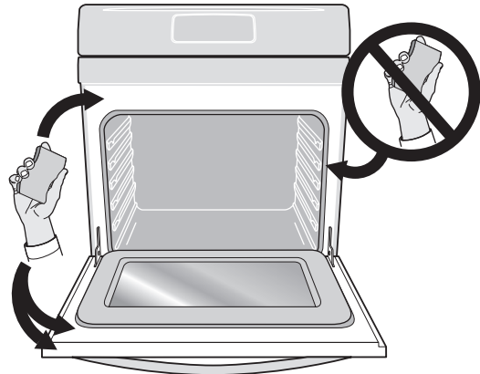
Figure 9: Limpie alrededor de la junta de la puerta del horno.
