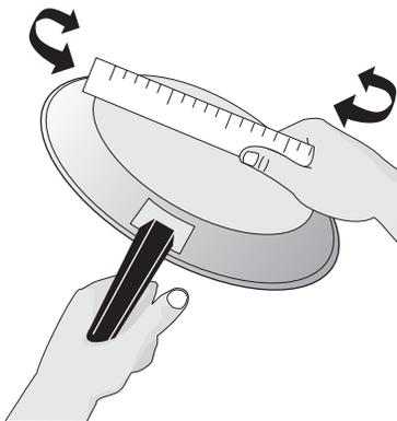
Figure 1: Mise à l'essai des ustensiles de cuisine
